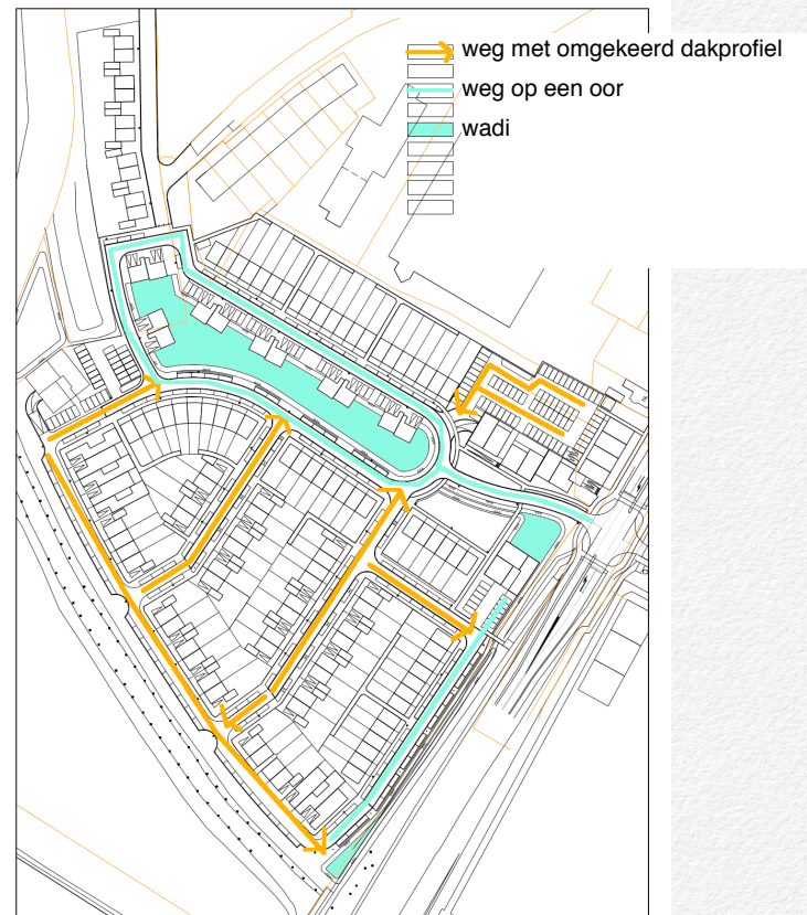
Waterafvoer via wegen
