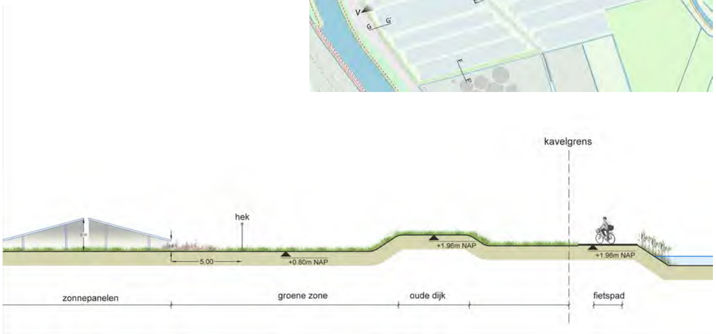
Doorsnede DD', Oostzijde met fietspad achter dijkje
