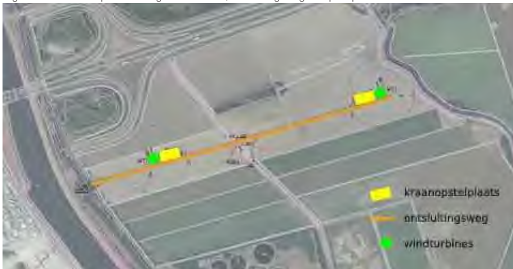
Figuur 4.4 Illustratie positionering windturbines, ontsluitingsweg en opstelplaatsen
