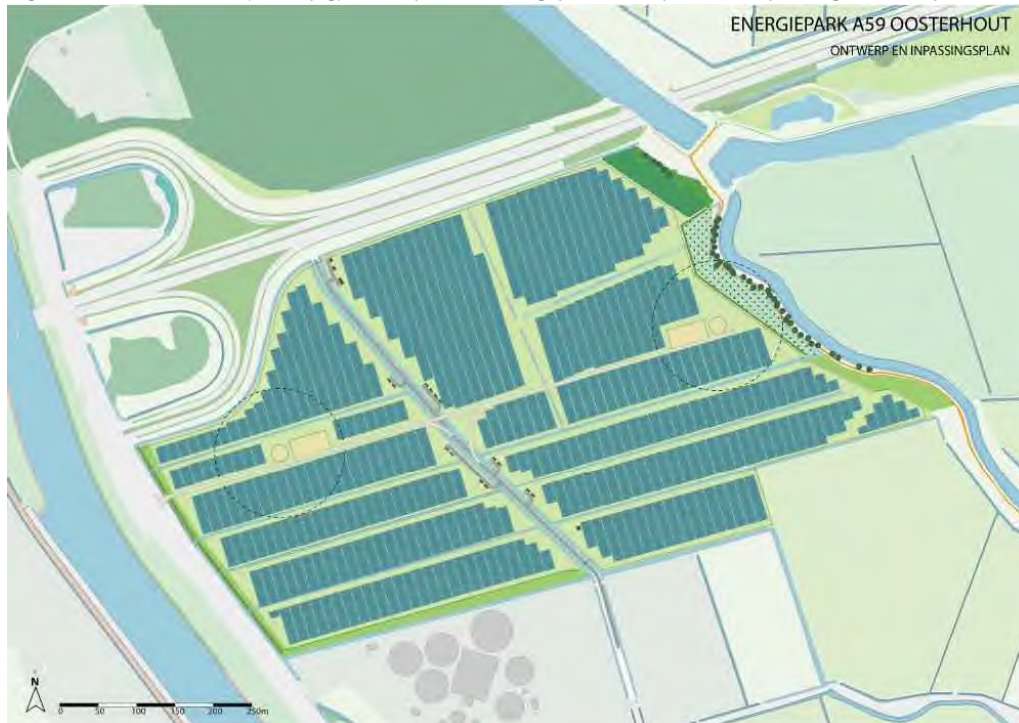
Figuur 4.6 Ter illustratie: (voorlopig) ontwerp en inrichtingsplan zonnepark met inpassing definitief plan windturbines
