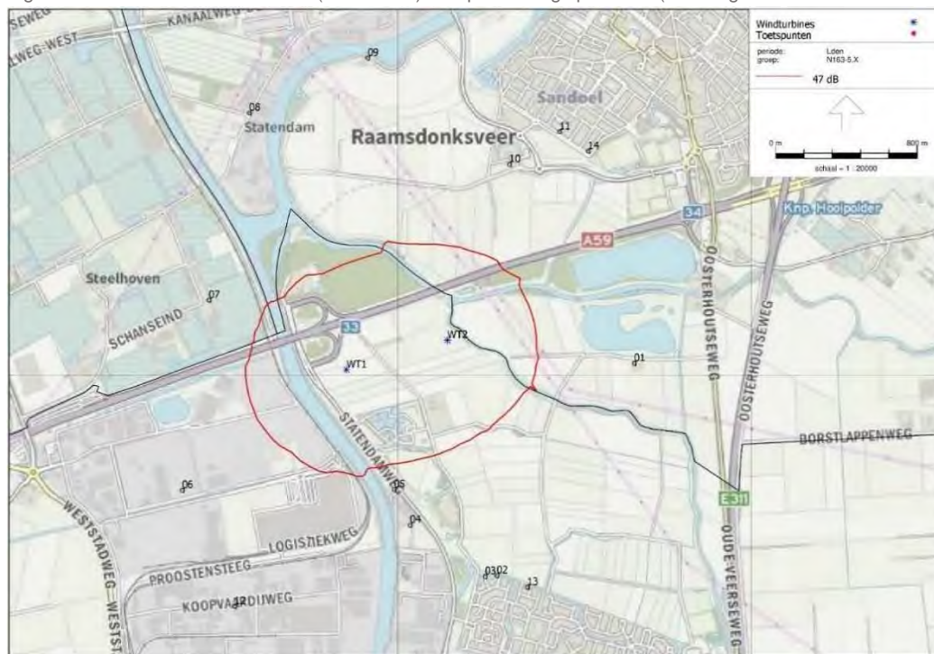
Figuur 5.1 Geluidcontour L_{den} 47 dB (worst-case) windpark Energiepark A59 (rekening houdend met komst zonnepark)
